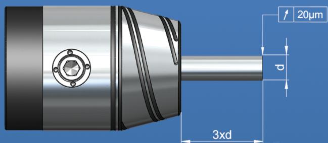
Das Bohrfutter wird mit einem Sechskant – Quergriffschlüssel seitlich über einen Kegeltrieb gespannt. Drehen Sie den Schlüssel im Uhrzeigersinn, um das Bohrfutter zu spannen; gegen den Uhrzeigersinn, um das Bohrfutter zu öffnen.
